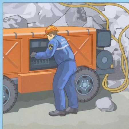
Подача воздуха в заваленные защитные сооружения с повреждёнными фильтровентиляционными системами
